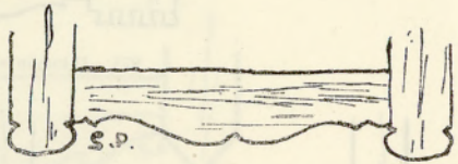
279. Ikkunan vuorilauta. Putrola.
